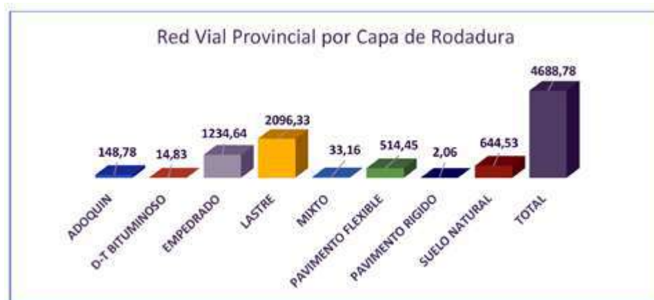
Gráfico 37 Superficie de rodadura de la red vial provincial
